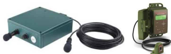
SM2bat (à gauche) et SM4bat de Wildlife acoustics (à droite) utilisés pour les points d'écoute passifs Source : Les Snats 2020
